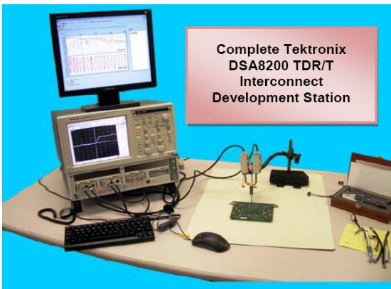
그림 5) Tektronix DSA8200 TDR system- Gigaprobe®는 80E10, 80E08, 80E04에 직접 연결할 수 있다. PPM100과 같은 Articulating arm을 사용하면 보다 안정적으로 프로빙을 할 수 있다.
