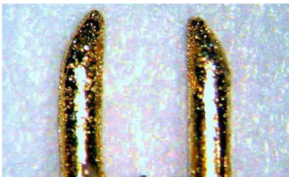
그림 4) Gold Plated Conductive Diamond Probe Tips- 프로브 팁의 100여개의 금도금된 날카로운 다이아몬드 팁은 프로빙을 했을 때, PCB pad 표면의 산화막을 뚫게 되어 솔더링을 한 것과 같은 완벽한 접촉이 된다. 도전성 다이아몬드 팁은 어느 각도에서 프로빙을 하여도 안정된 접촉을 하게 된다.
